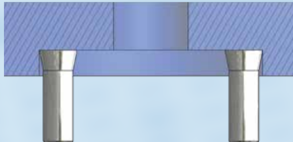
Messen eines Sacklochs Flat Bottom measurement
