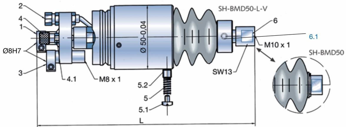
Schwimmhalter mit Auflaufsicherung werden im allgemeinen zur vollautomatischen Messung verwendet. Der Schwimmhalter ist gegen Verdrehen gesichert.
