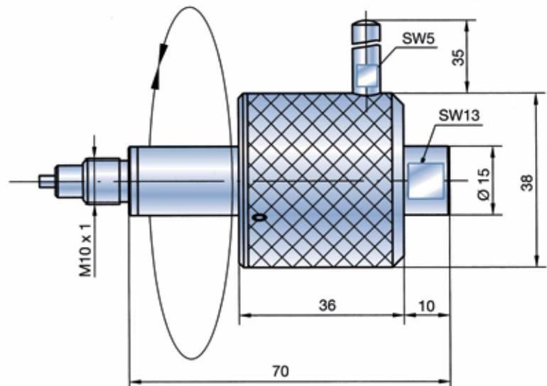
Zum Messen tiefer Bohrungen in Verbindung mit elektr. Mess-tastern (3) und entsprechend langem Kabel oder Verlängerung. Zur besseren Führung im Werkstück empfehlen wir die Verwen-
