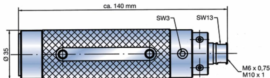
BMD-Adapter ermöglichen den Anschluss von BMD-Typen mit kleinerem Gewinde an BMD-Zubehörelemente mit größerem Gewinde.
