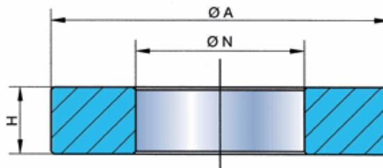
Genauigkeiten der DIA TEST-Einstellringe (Werknorm):
