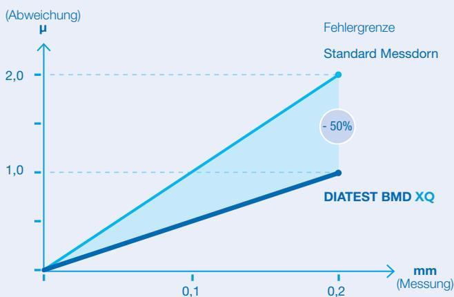
Durch die stark erhöhte Mess-Sicherheit können Sie beruhigt der Tendenz zu immer engeren Toleranzen begegnen. Besonders in Verbindung mit der digitalen Anzeige DIATRON1000 und dessen Auflösung von 0,1 μm können Sie sicher sein, dass Ihre Messwerte absolut korrekt sind. Eine Linearisierung des kompletten Mess-Systems, bspw. nach VDA Band 5, ist möglich.
