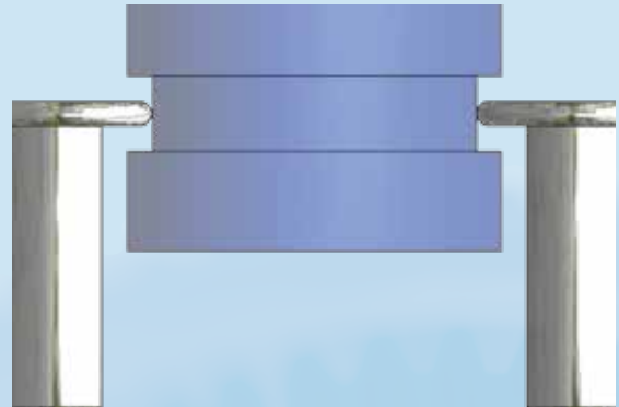
Messen des Durchmessers einer Außennut Measuring of an outer groove diameter
