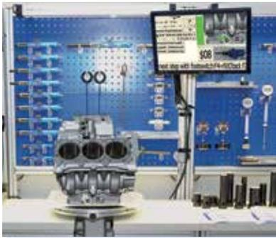
Anzeigende, selbstzentrierende Messinstrumente garantieren durch Eigenzentrierung eine exakte Messung
