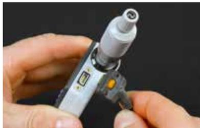
Gummidichtung, um das Batteriegehäuse bzw. den Datenausgang gegen von außen eindringende Verschmutzung zu schützen.
