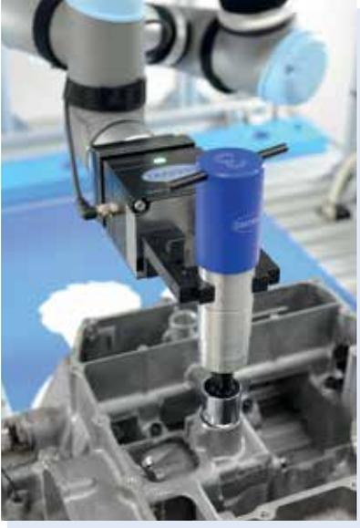
Automatische Messzelle: autonomes, robotergestütztes Messen mit einem Bohrungsmessdorn
