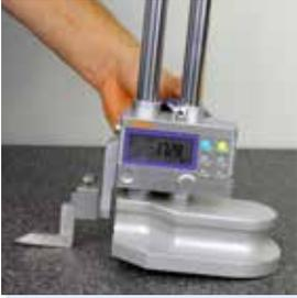
Übermäßige Abwärtskraft hebt den Sockel von der Platte ab.
