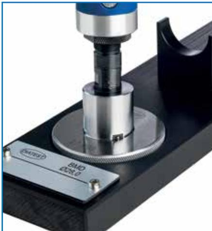
Nullstellung eines Bohrungsmessdorns
