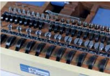
Messgeräte mit auswechselbaren Tastköpfen erfordern nach Austausch des Tastkopfs eine erneute Referenzeinstellung. Dies geschieht bspw. durch die Verwendung von Einstellringen
